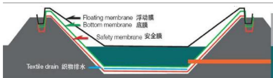
图 4-1 黑膜厌氧池存储示意图
